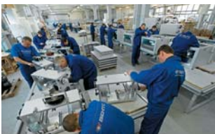
Цех изготовления приточно-вытяжных установок
