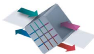
Принцип работы пластинчатого рекуператора перекрестного тока
