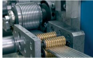
Цех изготовления гибких воздуховодов
