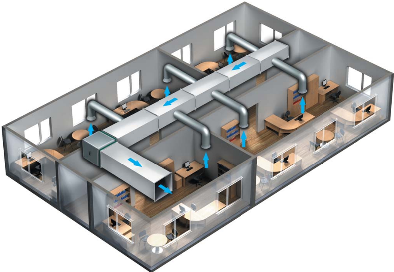
Вариант применения вентилятора ВШ ЕС в офисном помещении
