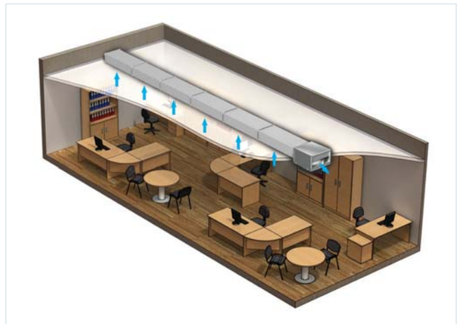
Вариант применения вентилятора ВКПФИ в офисном помещении
