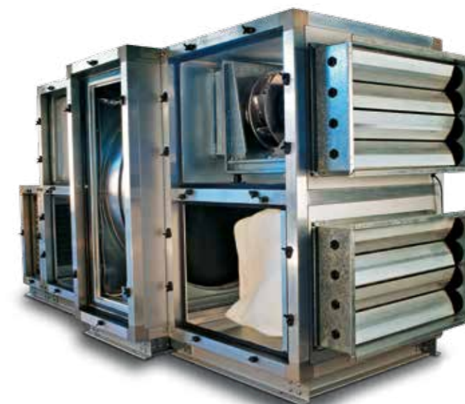
Агрегаты классической конструкции выполнены в корпусах из панелей толщиной 50 мм с алюмоцинковым покрытием на рамах из профиля толщиной 50 мм.
