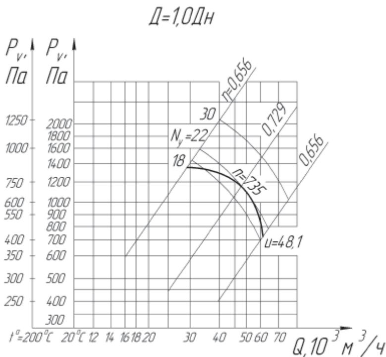
Аэродинамические характеристики вентиляторов радиальных ВЦ 4-75-10 (V исполнение)
