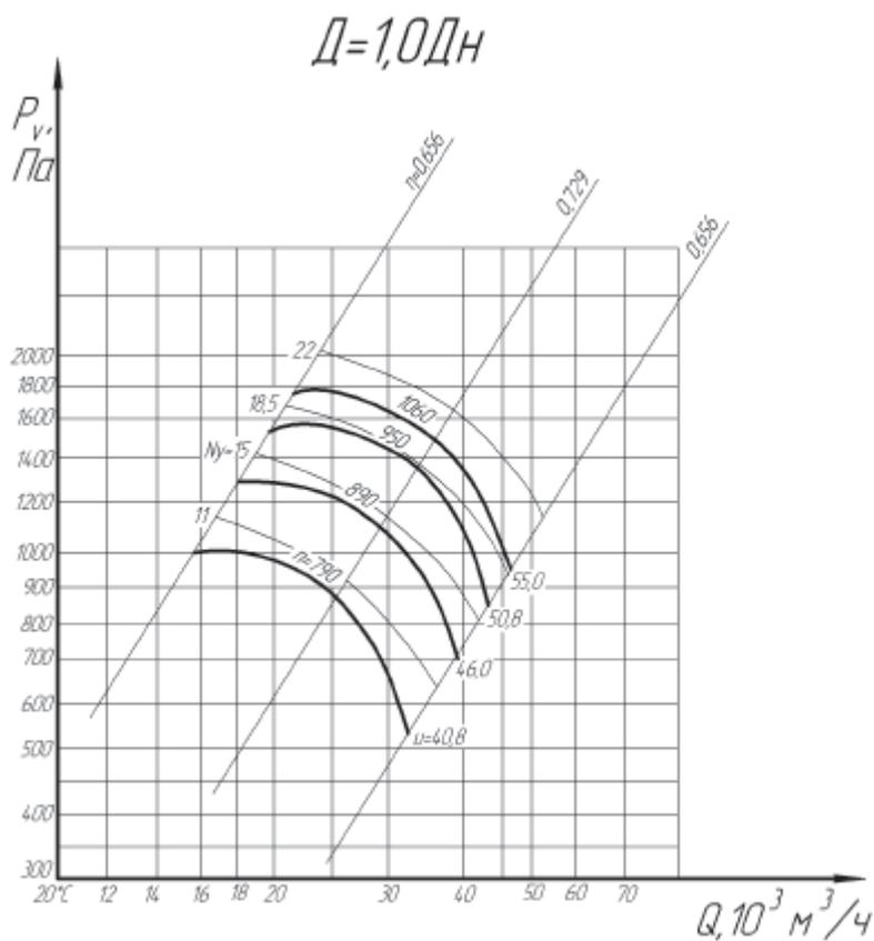
Аэродинамические характеристики вентиляторов радиальных ВЦ 4-75-12,5 (V исполнение)
