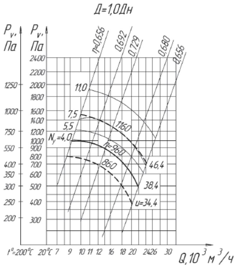
Аэродинамические характеристики вентиляторов радиальных ВЦ 4-75-10 (I исполнение)
