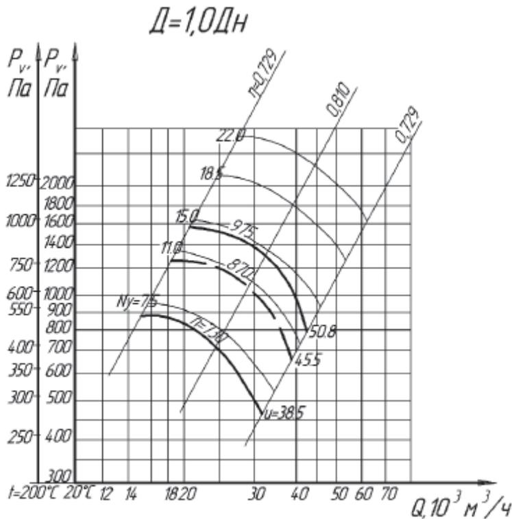
Аэродинамические характеристики вентиляторов радиальных ВЦ 4-75-12,5 (I исполнение)
