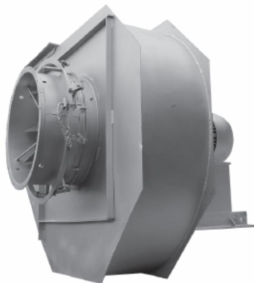
Для различных эрозионных свойств транспортируемого дымового газа дымососы типа ДН изготавливаются с противоизносной защитой внутренних улиток и лопаток рабочих колес-базовое исполнение.
